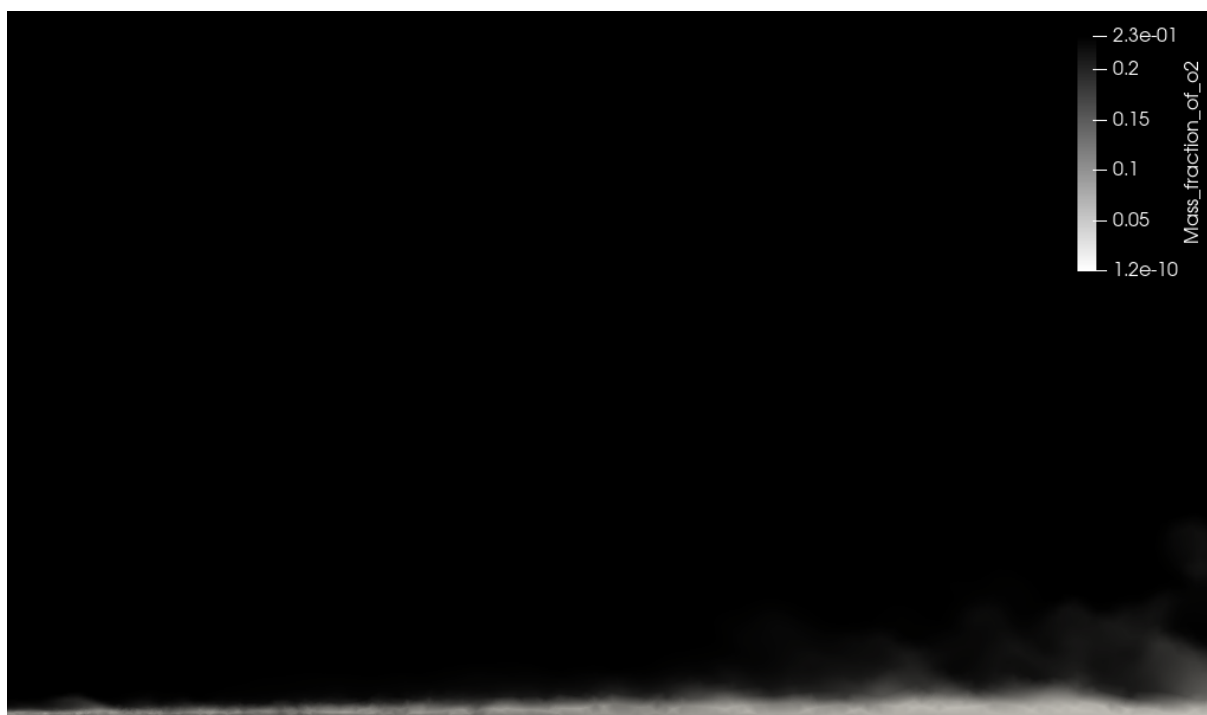
Figura 9 – Fração mássica de O_2 . Última iteração da simulação. t=0,5s
