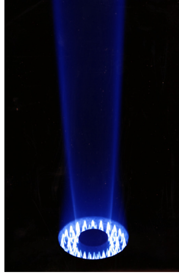
Figura 4 – Chama D, com ênfase na saída do jato principal(circunferência interna) e da chama piloto(anel).
